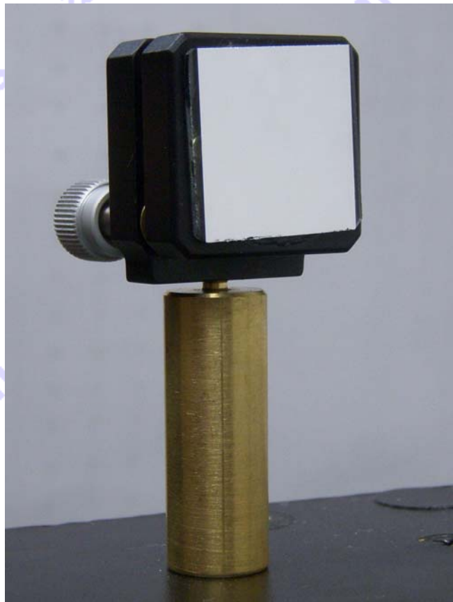
Καθρέπτης και κινούμενη βάση με δύο βίδες για ρύθμιση (με την ετικέτα Β).
