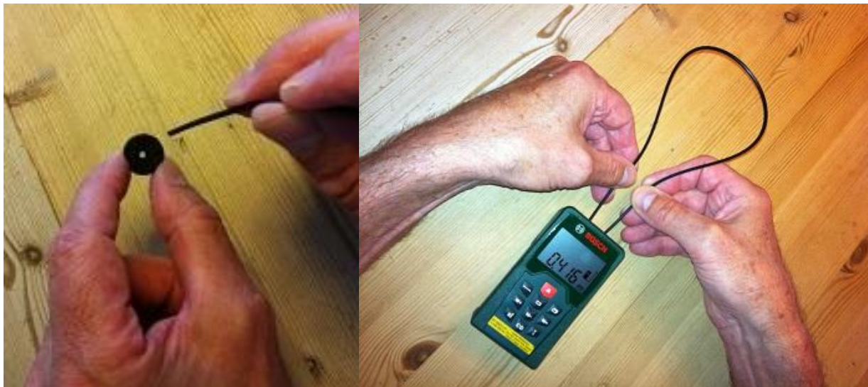
Εικόνα 1.5 (a) Ταμπόν και καλώδιο οπτικής ίνας. (b) Τοποθετώντας το καλώδιο οπτικής ίνας.
