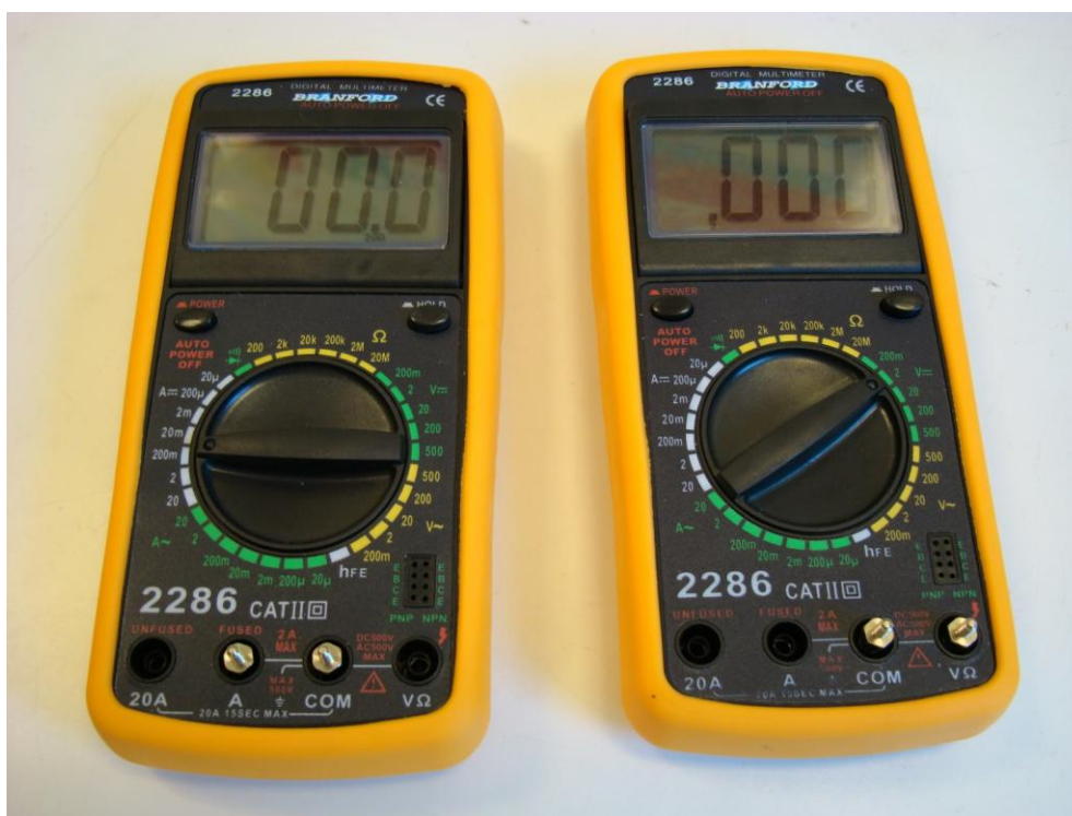
Εικόνα 2.3 Πολύμετρα εφοδιασμένα με τερματικά για χρήση ως αμπερόμετρο ( αριστερά ) και βολτόμετρο ( δεξιά ), αντίστοιχα. Το όργανο τίθεται σε λειτουργία πατώντας το κουμπί “POWER” στην πάνω αριστερή γωνία. Το όργανο τίθεται εκτός λειτουργίας αυτόματα μετά από κάποιο χρονικό διάστημα αδράνειας. Μπορεί να μετρήσει συνεχές ρεύμα και τάση (=) καθώς επίσης και εναλλασσόμενα (~). Η εσωτερική αντίσταση του βολτομέτρου είναι 10 MΩ ανεξάρτητα από την κλίμακα μετρήσεων. Η διαφορά δυναμικού στα άκρα του αμπερομέτρου είναι 200 mV σε πλήρη μέτρηση, ανεξάρτητα από την κλίμακα μετρήσεων. Σε περίπτωση υπερχειλίσης, θα εμφανιστεί στην οθόνη η ένδειξη “1”, οπότε πρέπει να επιλέξετε μια ευρύτερη
