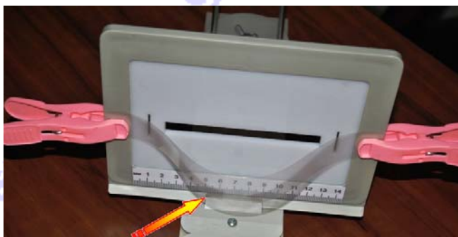
Εικόνα 1B: Πειραματική διάταξη για τη μελέτη της διπλοδιαθλαστικότητας στον χάρακα
