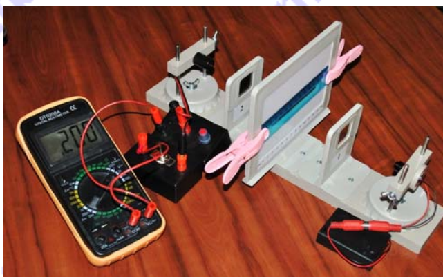
Εικόνα 4B: Πειραματική διάταξη για τη μελέτη της διέλευσης του φωτός μέσα από τον πλαστικό χάρακα
