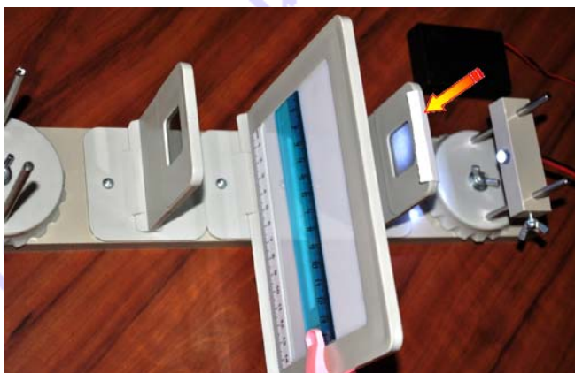
Εικόνα 1B: Πειραματική διάταξη για τη μελέτη της διπλοδιαθλαστικότητας στον χάρακα
