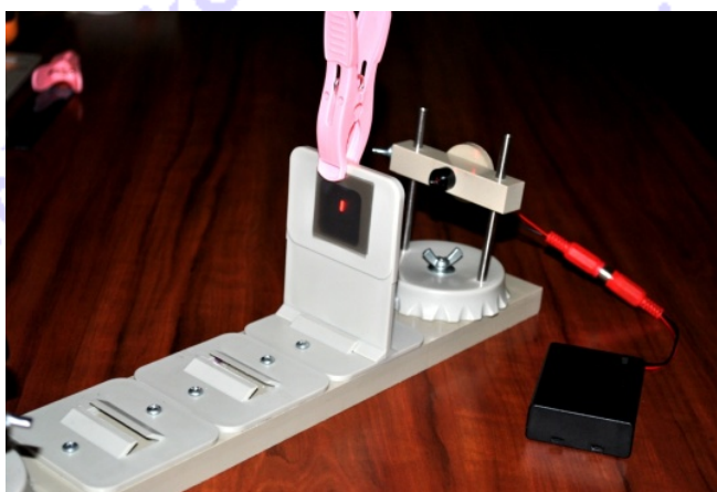
Εικόνα 5B: Τα φίλτρα στερεωμένα στον πολωτή
