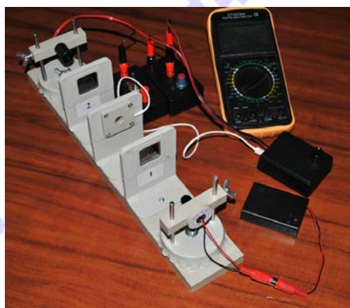
Εικόνα 6B: Πειραματική διάταξη για τη μέτρηση της χαρακτηριστικής της LCC
