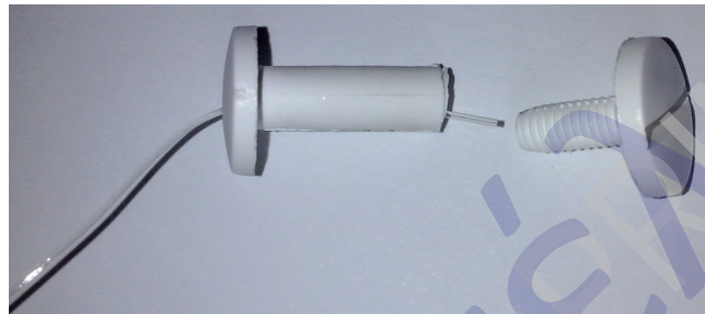
Εικόνα 6. Μέθοδος στερέωσης του νήματος TPU στη βίδα.
